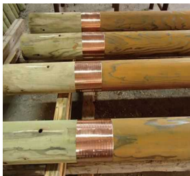
固形木材防腐剤打込の上銅板巻を施す
